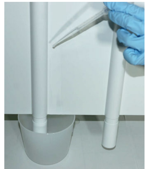
Abbildung 3: Rohr in Becher abspülen
