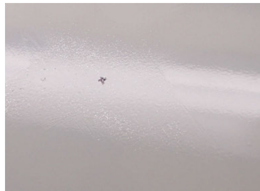
Abbildung 22: Überlackierter, zu dick aufgetragener, Ölfilm (kein LABS-Fehler) HINWEIS: Im Zentrum befindet sich eine Markierung für den Kamerafokus.
