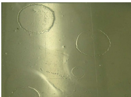
Abbildung 23: Überlackierbare Lösemittelränder (kein LABS-Fehler)
