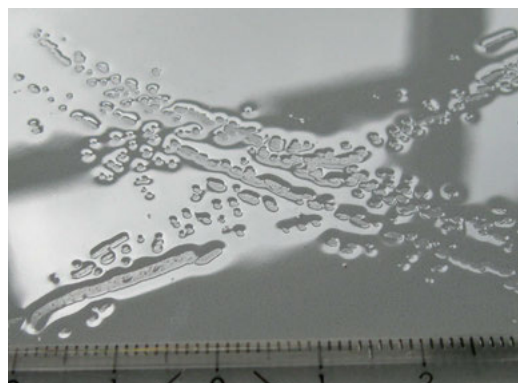
Abbildung 13: Benetzungsstörung nach Abrieb (LABS-Fehler)
