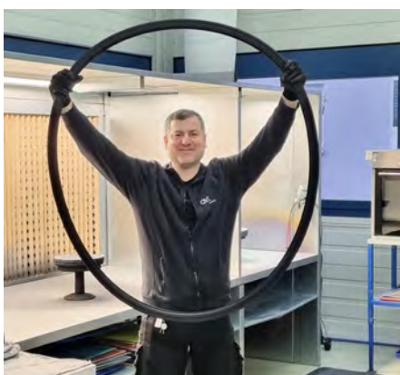
Bild 3: Beschichtet werden nicht nur Großserien ab Stückzahlen von einer Million aufwärts – es werden auch schon mal einzelne, „riesige“ Dichtungsringe beschichte (Bild: OVE Plasmatec GmbH)
