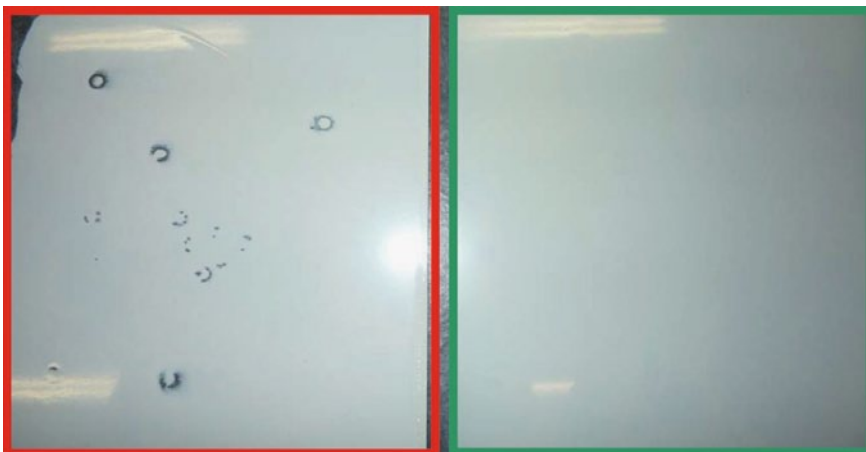
Ein LABS-Test nach der Prüfvorschrift VW PV 3.10.7: Die Beschichtung links ist nicht in Ordnung, da sich Krater im Lack befinden. Rechts ist die Beschichtung in Ordnung. Der Lack ist deckend und ohne Störungen.
