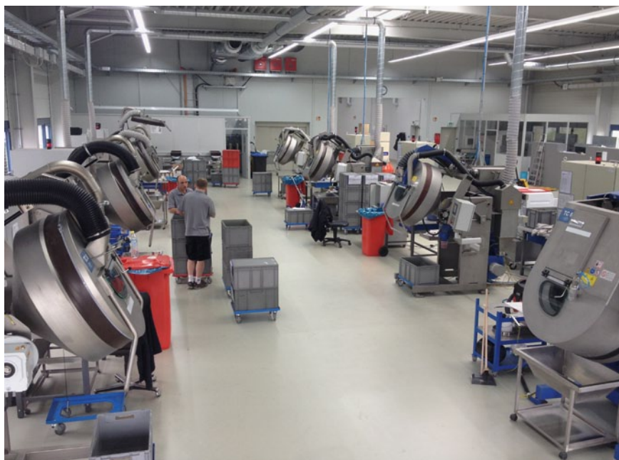
Die Gleitlackbeschichtung auf Wasserbasis wird in Trommel-Sprühanlagen auf die Dichtungen aufgebracht
