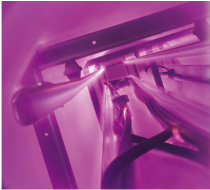
Bild 1: Durch das Plasmaverfahren werden nicht nur verbliebene oberflächliche Fertigungshilfsmittel entfernt, sondern auch, je nach Materialzusammensetzung, diffundierte, ungebundene Mischungsbestandteile wie Weichmacher aus Elastomeren herausgelöst (Bild: OVE Plasmatec GmbH)
