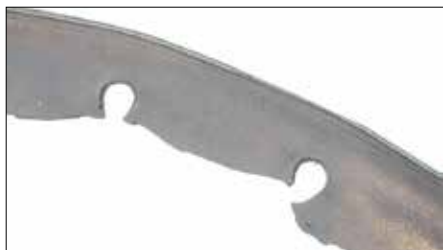
Bild 1: Flachdichtung, in Öl gequollen Sollwerkstoff: NBR, fälschlich eingesetzt: NR (Bild: O-Ring Prüflabor Richter GmbH)
