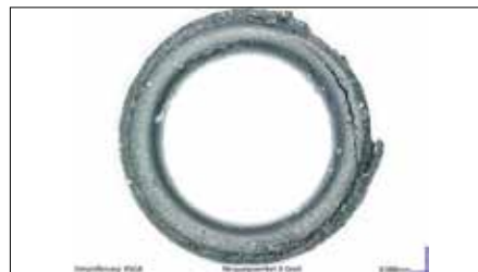
Bild 3: Verwechslung der Werkstoffhärte: Statt einem NBR mit 90 ShA wurde ein NBR mit 70 ShA verwendet, der dann aufgrund der schwierigen Montagesituation zerstört wurde (Bild: O-Ring Prüflabor Richter GmbH)
