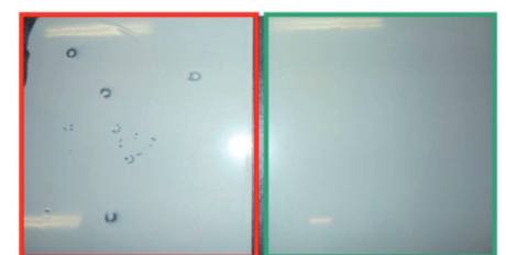
Abb. 5: Ergebnisse LABS-Test nach VW PV 3.10.7
